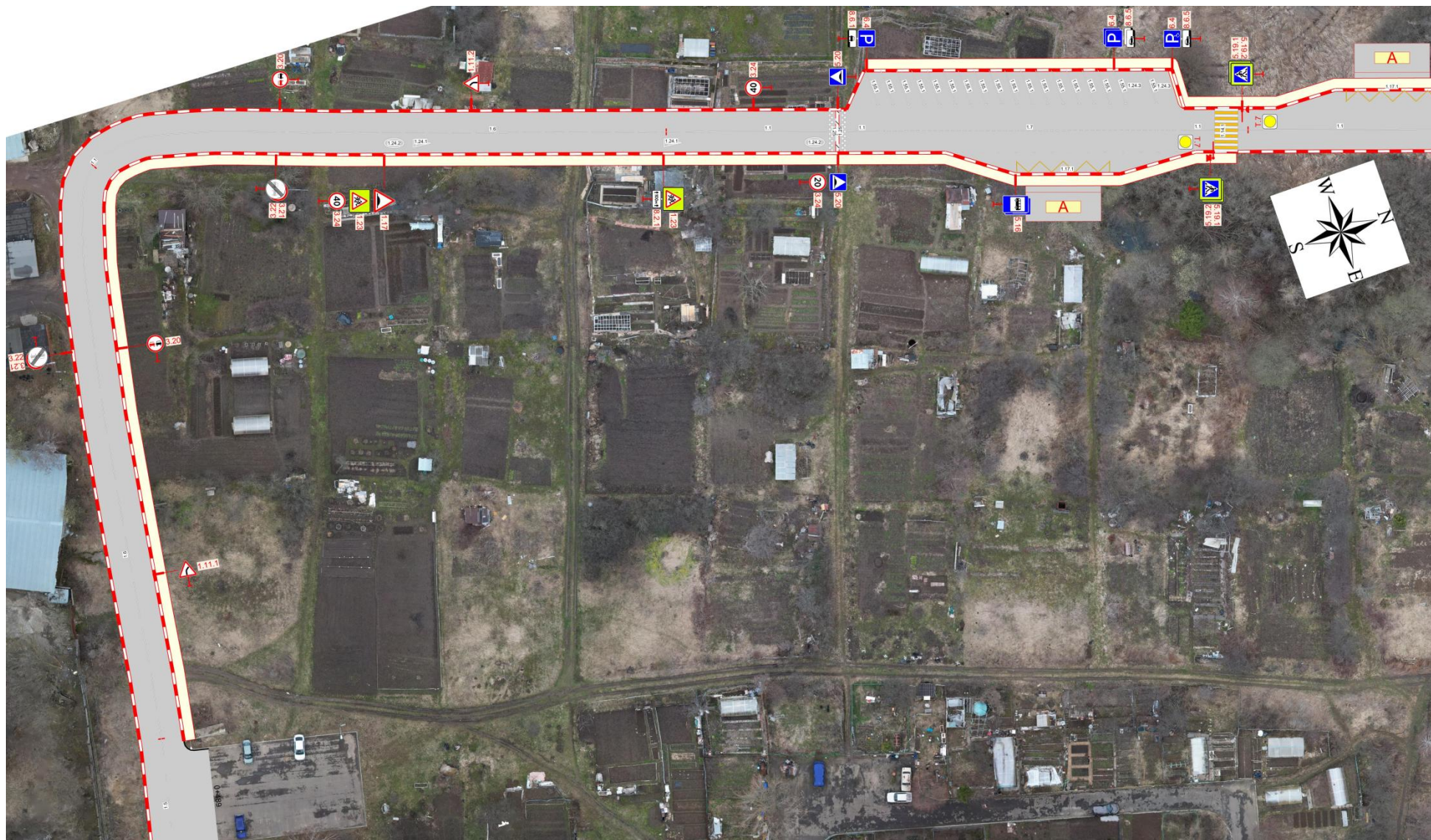
Рисунок 3.7 – Схема ОДД на подъезде к новой школе (участок км 0 + 530 – км 0 + 793)
