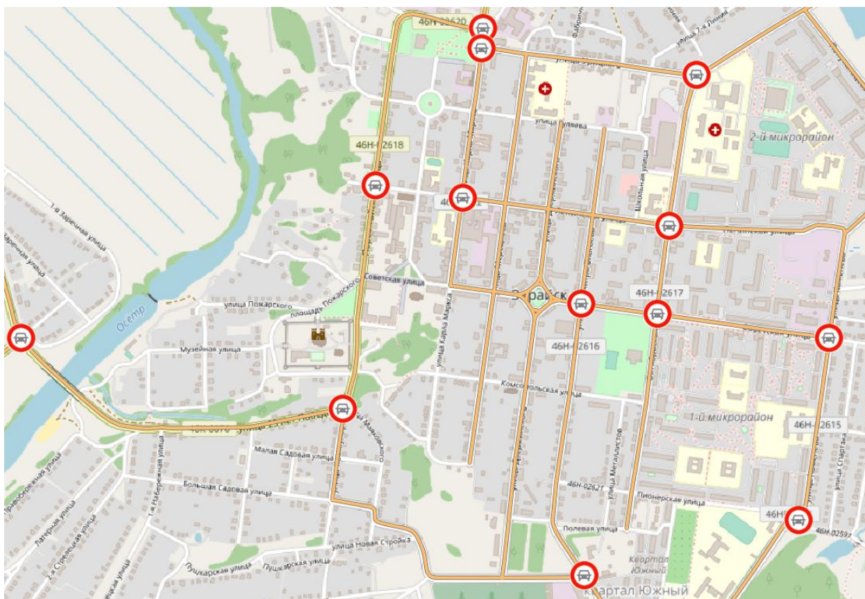
Рисунок 1.41 – Места замеров транспортных потоков в центральной части г. Зарайск
