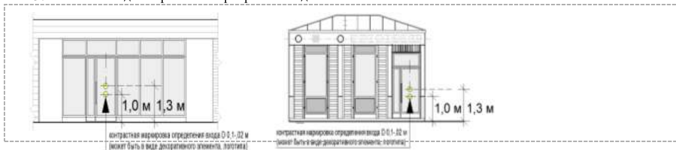
Рис. 37. Внешний вид контрастной маркировки входа.
