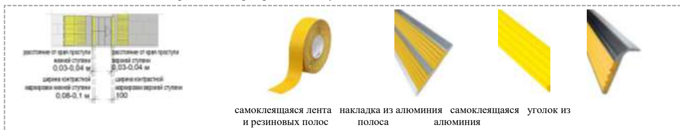
Рис. 36. Внешний вид контрастной маркировки на ступенях.
